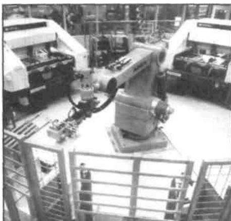
Figura 9 - Robot para perforación de circuitos impresos.
