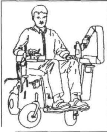
Fig. 16 - Silla de ruedas automatizada con manipulador
